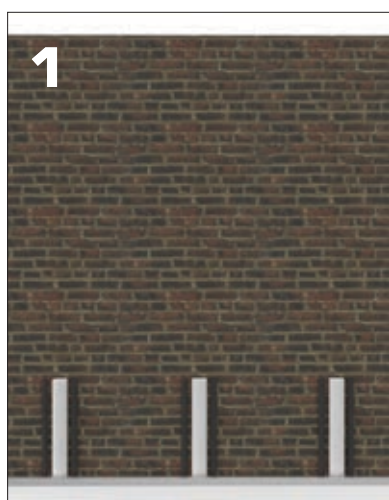
1. Wypoziomuj i zamontuj do posadzki profil dolny.
